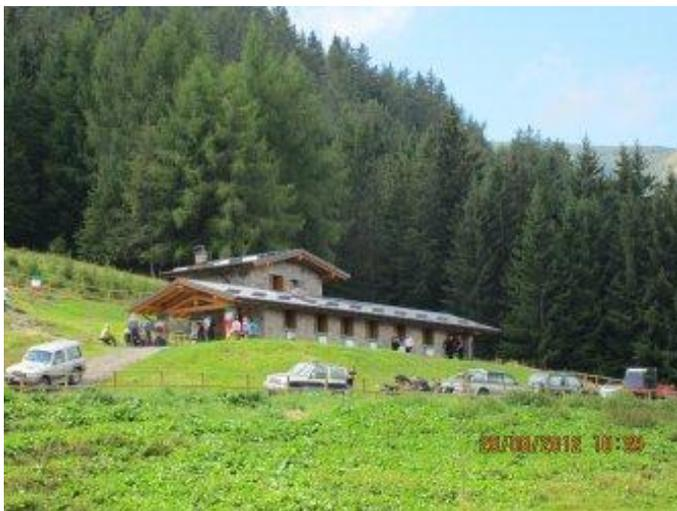
Malga Piazzalunga, da diversi anni, era ridotta ad un rudere **completamente diroccato** e, di conseguenza, le nuove strutture del fabbricato sono state realizzate ricostruendo le murature con i **conci di pietra recuperati**. Il tetto di copertura è stato realizzato con *lamiere grecate* su orditura di travi di legno d'abete. Anche a Piazzalunga è stato realizzato un impianto elettrico alimentato da **pannelli solari fotovoltaici**.
